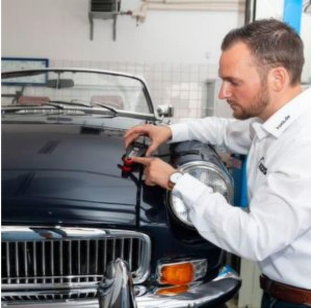
Die Prüfumfang bei einer Kurzbewertung kann sehr unterschiedlich ausfallen. Manchmal kontrolliert sogar die Lackschichtdicke. (Bild: Christian Sabo)
