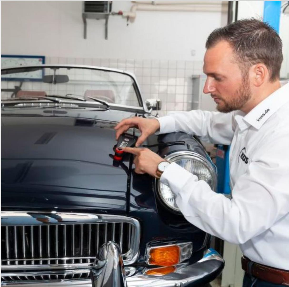
Die Prüfumfang bei einer Kurzbewertung kann sehr unterschiedlich ausfallen. Manch einer kontrolliert sogar die Lackschichtdicke. (Christian Sabo)
